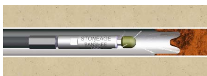
Роторные насадки для очистки труб и трубок теплообменников
